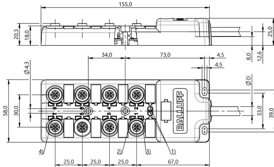
1) Indicatore di funzionamento verde, 2) LED giallo per segnale 1 (NA), 3) LED giallo per segnale 2 (NC), 4) Numerazione slot
