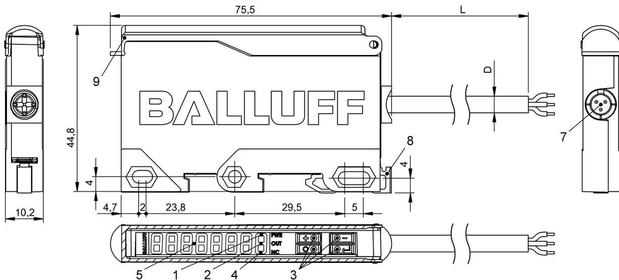
1) Tensione d'esercizio LED, 2) Indicatore di funzione LED, 3) 4x tasto di azionamento, 4) LED funzione contatto NC attiva, 5) 7x indicatore a sette segmenti, 7) Collegamento a spina sensore, 8) Montaggio rotaia profilata 35mm, 9) Sportello
