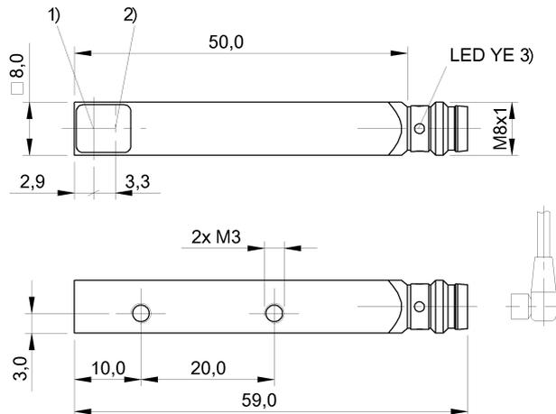
1) Asse ottico emettitore, 2) Asse ottico ricevitore, 3) Funzione in uscita
