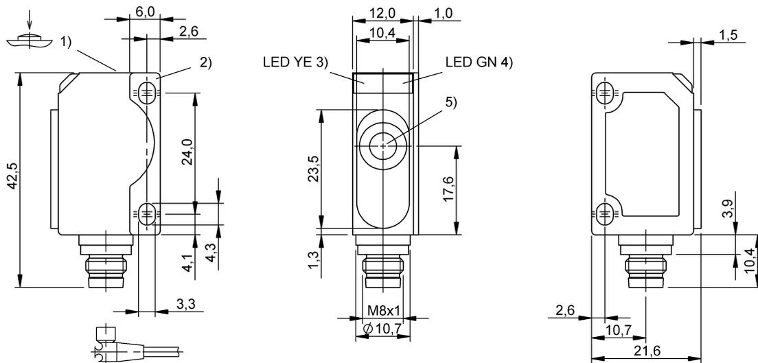
1) Regolazione sensore, 2) Piastra di fissaggio, 3) Indicatore di stato, 4) Tensione d'esercizio/modalità di esercizio, 5) Asse trasduttore di ultrasuoni
